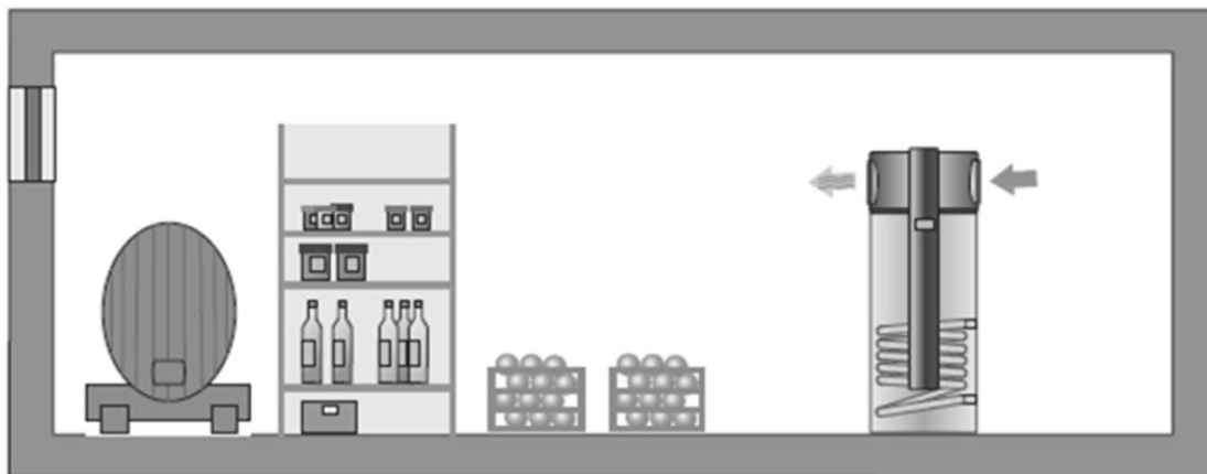
1. ábra: A levegőt ugyanabból a helyiségből vonják el, és ugyanabba a helyiségbe fújják ki (pl. alkalmas a helyiség hűtésére).
