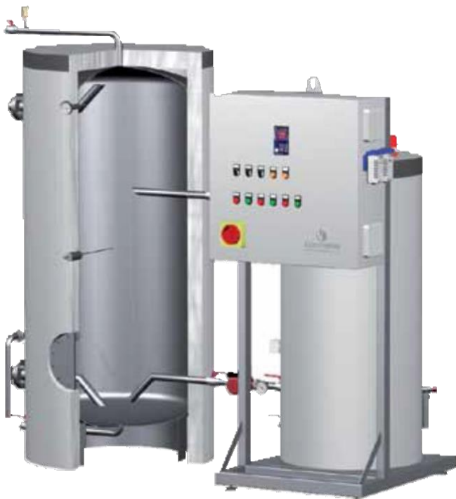
HMV-termelő külső Incoloy 825 fűtőelemekkel, a tartály leeresztése nélkül eltávolítható
