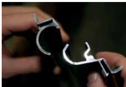
A szabadalmaztatott alumínium zárócsíkok lehetővé teszik a külső burkolat egyszerű és gyors kinyitását egyetlen személy által.
